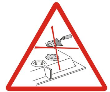
Le contact direct de plâtre ou de colle pour plaques ou carreaux de plâtre avec la sous-face du receveur est à proscrire. Il ne doit pas y avoir de blocage vertical ni latéral du receveur.
